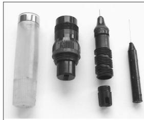
*Imagen 34B. Estilógrafo Rotring recargable para dibujo técnico de 0.5 mm desarmado.*
